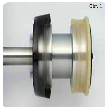
Zařízení na zkoušení klecí: Porovnání standardní polyamidové klece a klece E2 při otáčkách 8 000 min -1 . Klec E2 vpravo vykazuje podstatně menší deformace.
